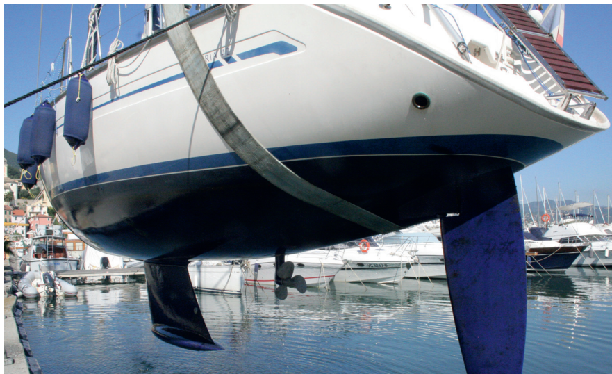
Sopra, la carena del Bavaria 42 dopo sei mesi di prova in mare dell'antivegetativa della Seajet. A destra, il particolare della chiglia e in basso a sinistra il barattolo della vernice usata.
