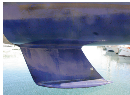
Sopra, la carena del Bavaria 42 dopo sei mesi di prova in mare dell'antivegetativa della Seajet. A destra, il particolare della chiglia e in basso a sinistra il barattolo della vernice usata.
